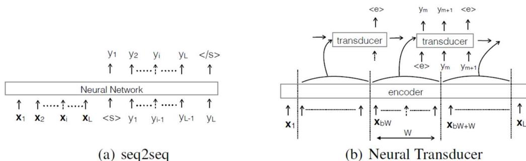
上図の(a)は一般的な seq2seq モデルを示している。時系列のデータ  $x_1 \sim x_L$  が入力され、予測される時系列データ  $y_1 \sim y_L$  が出力される。これに対し、論文におけるニューラルトランスデューサでは、エンコーダによりブロック毎に入力データの特徴量がトランスデューサに入力され、トランスデューサから予測される時系列データがリアルタイムで出力される。
