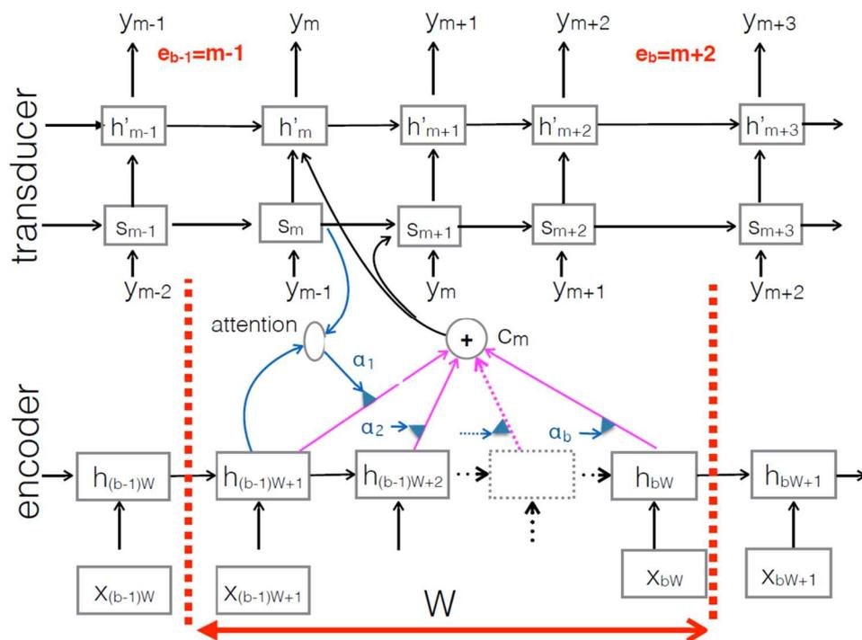
上図は論文に示されているニューラルトランスデューサアーキテクチャである。エンコーダは、入力された音声データ  $x_i$  ( $i=1 \dots L$ ) から、各タイムステップ  $i$  において、隠れ状態ベクトル  $h_i$  を生成する。
