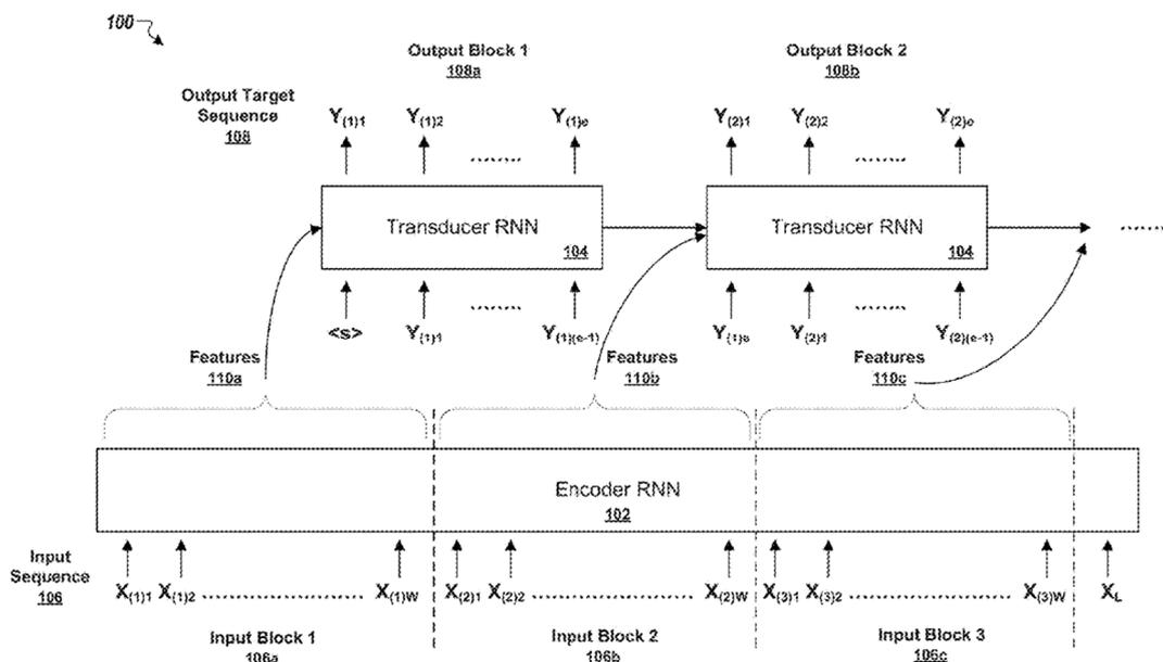
具体的には、入力シーケンスの固定数の入力タイムステップで構成される各ブロックについて、システムはエンコーダーリカレントニューラルネットワーク (RNN) 102 を使用して入力タイムステップのブロック 106a, 106b, 106c の各入力を処理し、入力のそれぞれの特徴表現 110a, 110b, 110c を生成する。RNN には LSTM (Long short-term memory) を使用する。
