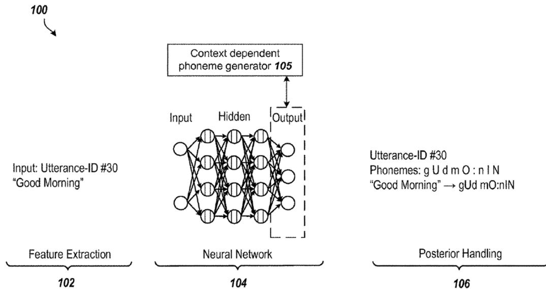
音響モデリングシステム 100 は、特徴抽出モジュール 102、ニューラルネットワーク 104、コンテキスト依存音素ジェネレータ 105、および事後処理モジュール 106 を含む。
