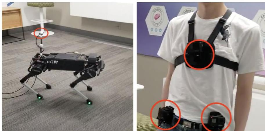
本論文では、3台のカメラ (右) を搭載した人間のデモンストレーションから、脚式ロボット (左) の視覚的ナビゲーションポリシーをトレーニングする学習フレームワークを示している。下記図はフレームワークを示す説明図である。
